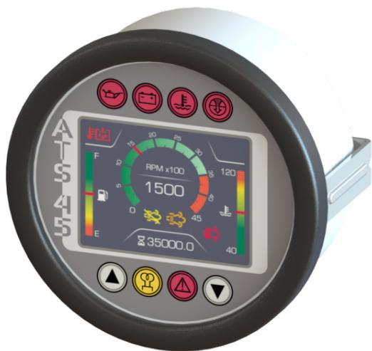
Strumento di diametro 100 mm dotato di 2 tasti per la programmazione, di 6 spie a led e di un display grafico 320x240 pixel a colori. Completo di ingressi analogici, digitali e uscite per il controllo e protezione di qualsiasi motore a diesel che permettono una grande flessibilità di utilizzo in svariati campi di applicazione, per esempio motopompe, macchine agricole e mezzi a lenta movimentazione.
